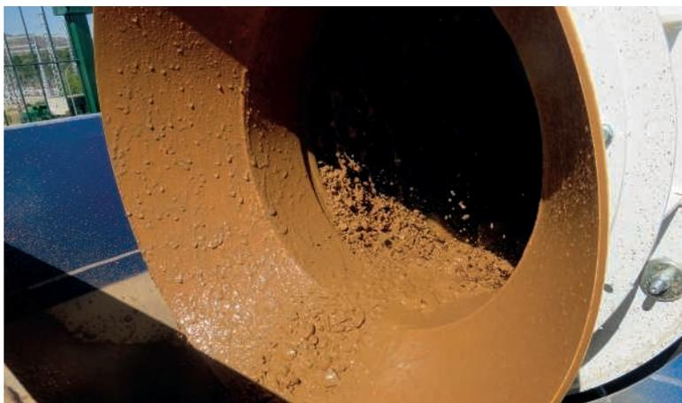
**Línea de clasificación granulométrica y separación de gravas.** Desde la tolva, se trasladan las tierras, mediante la cinta de alimentación de banda transportadora, hasta el primer equipo de lavado: cilindro de lavado ("tromel"). La mezcla de tierra lavada y agua de lavado se conduce por gravedad a una criba vibrante inclinada que permite clasificar granulométricamente.
