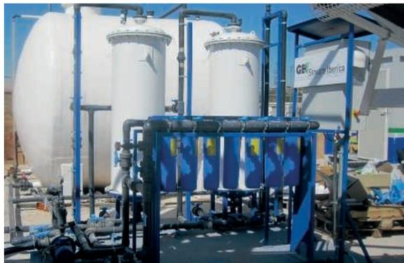
**Línea de tratamiento de agua.** El agua procedente de la deshidratación de finos se reincorpora al proceso o se envía a la Desplanta de tratamiento de agua. Ésta incluye los tratamientos hidratación planta de filtración e intercambio iónico (caso de ser necesario), que garantizarán el cumplimiento de los criterios radiológicos y medioambientales de vertido.
