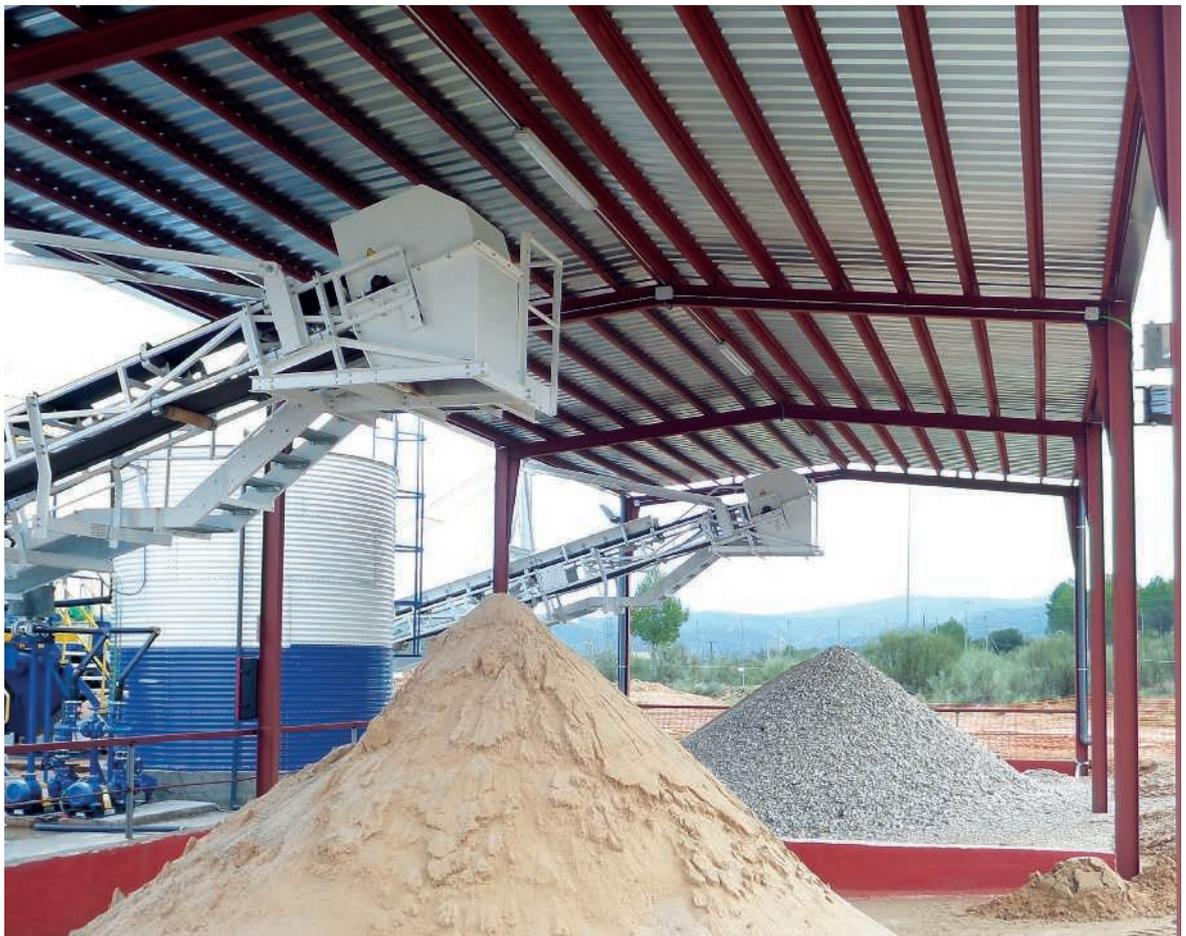
Separación de finos y lavado de arenas. La separación entre arenas y finos tiene lugar a través de dos fases de hidrociclado, antes y después de proceso de lavado denominado atrición. Las arenas se descontaminan mediante un proceso de rozamiento desprendiéndose la contaminación adherida. Las arenas obtenidas, una vez escurridas, se conducen por medio de una cinta transportadora hasta el acopio de arenas desclasificables.
