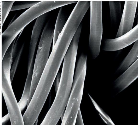
Observación de poliamida por un análisis de tipo SEM, microscopía electrónica de barrido.
