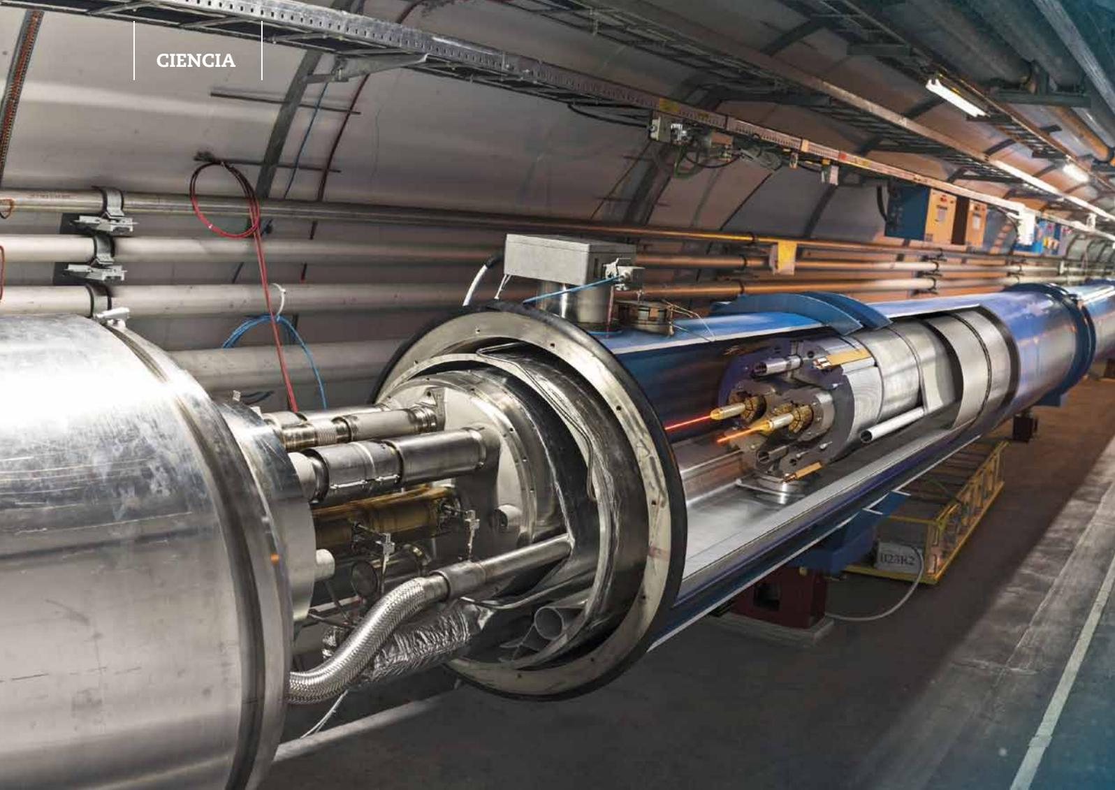
En el túnel circular, a una temperatura de menos 271,3°C, dos haces de protones en sentidos opuestos, colisionan mientras viajan a la velocidad de la luz.
